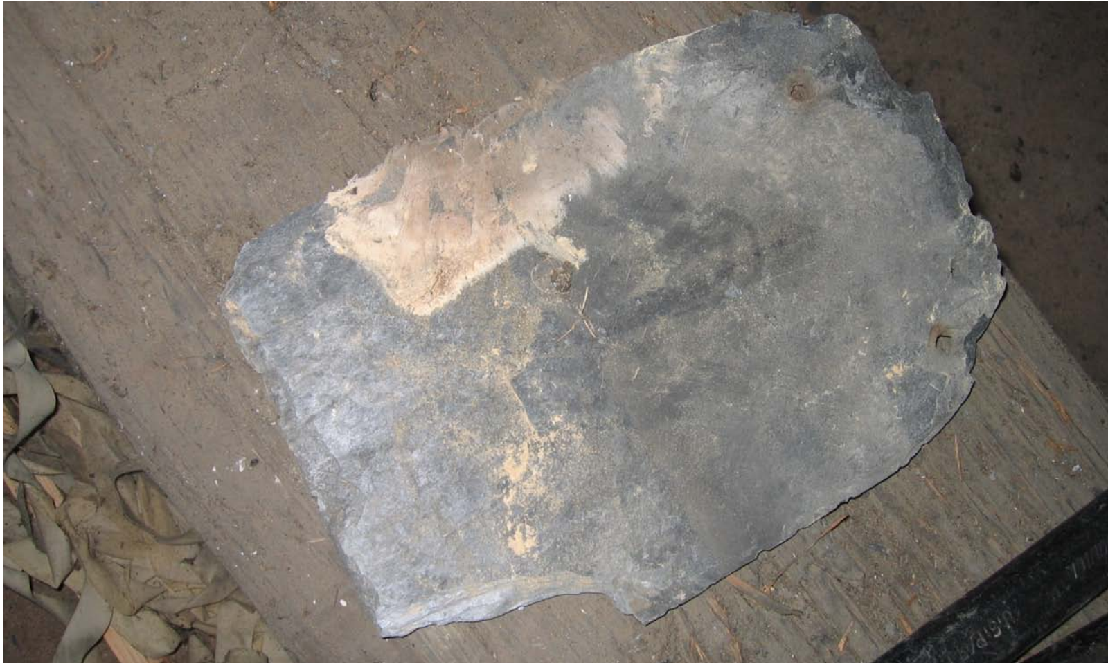
Dachdeckerschutt, Myzel Echter Hausschwamm
