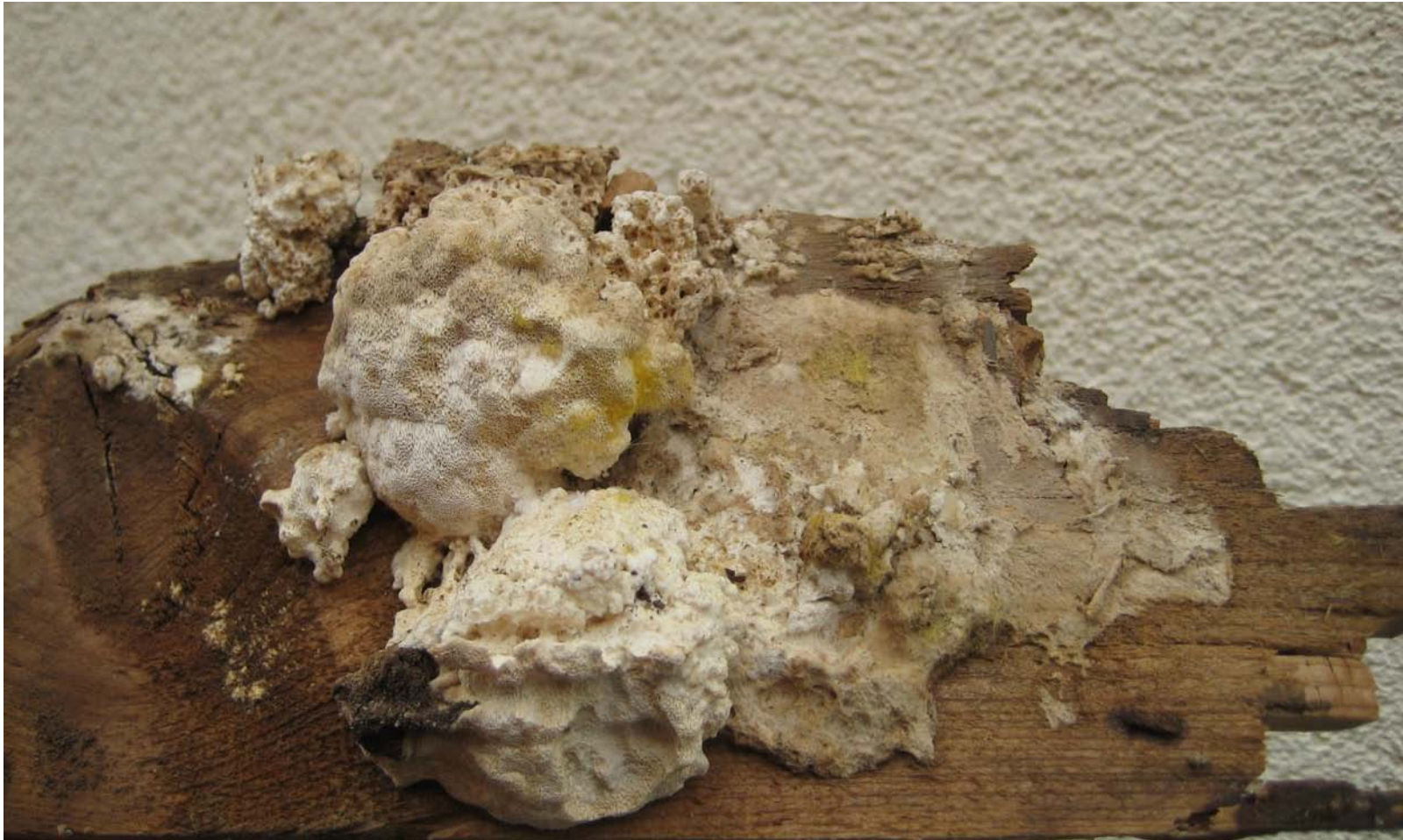
Weißer Porenschwamm – Fruchtkörper → Fäuletyp Braunfäule
